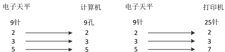
电子天平与计算机、打印机连线接线图
